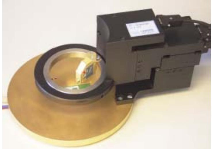
探头可以在集成电路表面进行三维移动并可以沿z轴旋转。扫描器的顶部是敞开的，允许用户使用显微镜观察探头位置。
