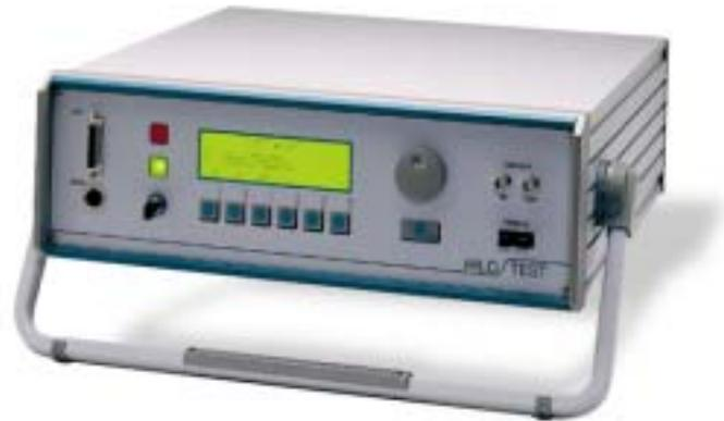
高压脉冲发生器 IPG 1201 是特别为测试元器件、绝缘体、空气和表面电弧间隙的介电强度而设计的。特别是可接触部位与有危险的工作部位之间的绝缘部分的抗浪涌能力，例如天线与电源终端的连接，请参阅 EN 60065。
