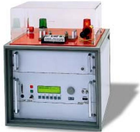
浪涌测试发生器PG-1520专为双间隙过压保护器的测试而设计。发生器产生两路浪涌电流脉冲输出，每路波形8/20 $\mu$ s、峰值 0.2-10 kA，并连续可调。同时还可以选择输出极性。
