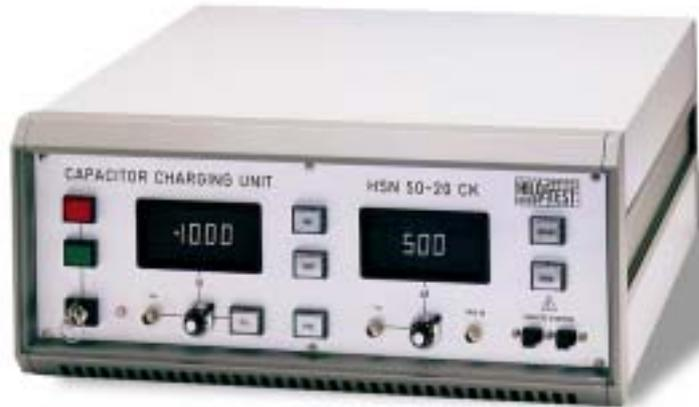
高精度电源系列HSN ...为开关电源，其始终频率为 20 kHz，具有波纹低和优越的调节特性。输出电压和电流稳定；二者均可通过电位计进行调整并显示在前面板上。另外，0 - 10 V的标准输出信号与输出电压和电流是成比例关系的，并可显示在监视器上。
