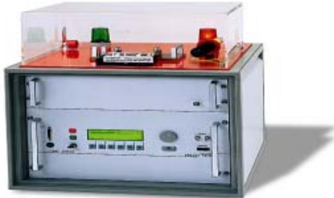
冲击脉冲发生器 EMC2004 用于满足 IEC、VDE 等标准要求的、对电子元件、过压保护器和电子线路的介电性能测试。基础版本的发生器产生的冲击电流波形为 8/20 $\mu$ s、峰值电流 0-25kA。除此之外，还有其它插入式模块可供选择。
