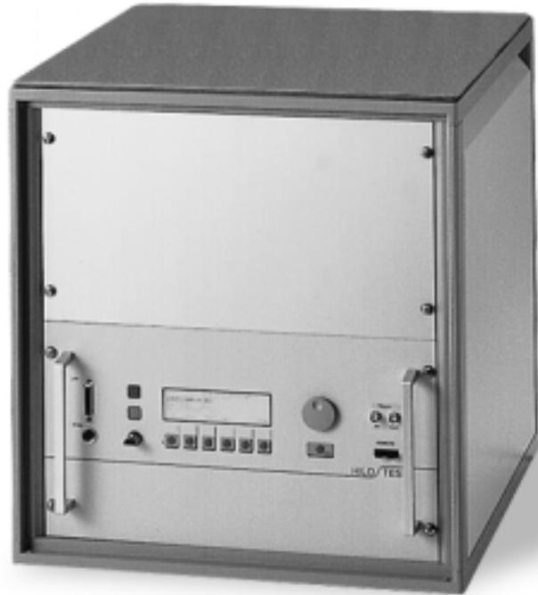
高压冲击脉冲发生器 PG 14-1960 产生标准的冲击电压波形 10/700 $\mu$ s。输出波形还可以切换为 0.5/700 $\mu$ s。输出幅度可在 0.2 kV 至 14 kV 之间进行调整。可选择并预制正、负、或交替的输出电压极性。
