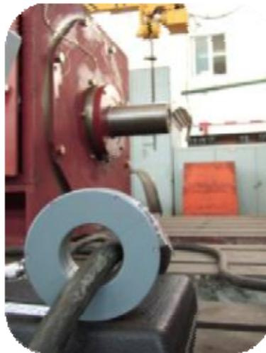
电源线传导发射测试 (CE101)
