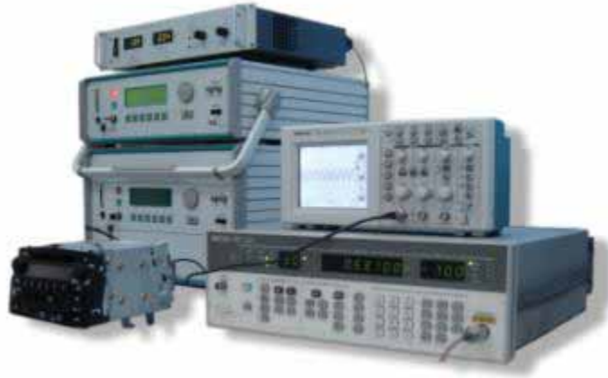
图 7 具体测试过程中的基础 ISO7637 瞬态传导测试系统
