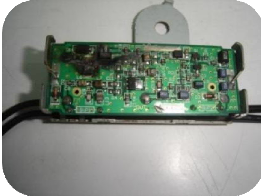
图 4 在进行#5a 波形试验时，某电源电路烧毁的车载电子产品
