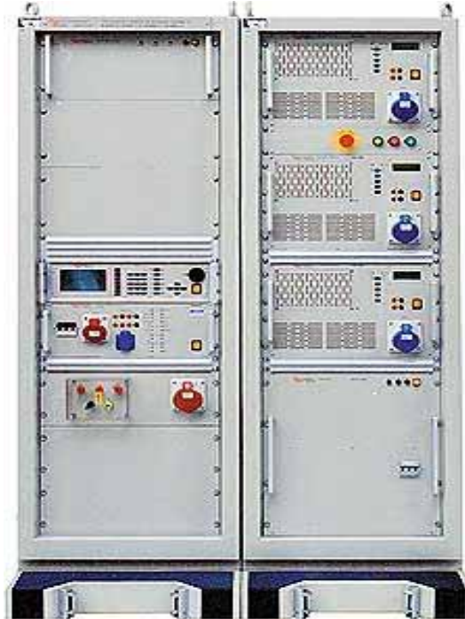
图六：电动汽车充电站的抗扰度测试设备
