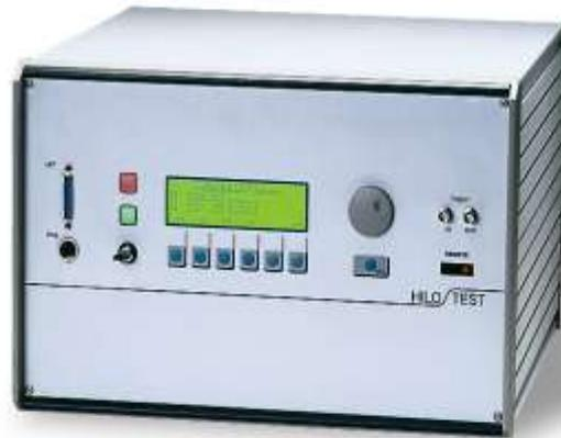
高压脉冲发生器 PG 10-200/12-360是专门用于测试太阳能电池组件（太阳能电池板）脉冲电压而设计的。发生器可产生满足IEC60060-1/2标准的浪涌电压波形1.2/50  $\mu$ s，电压可达10kV满足IEC 61730-1/2 和EN 61730-1的标准要求。
