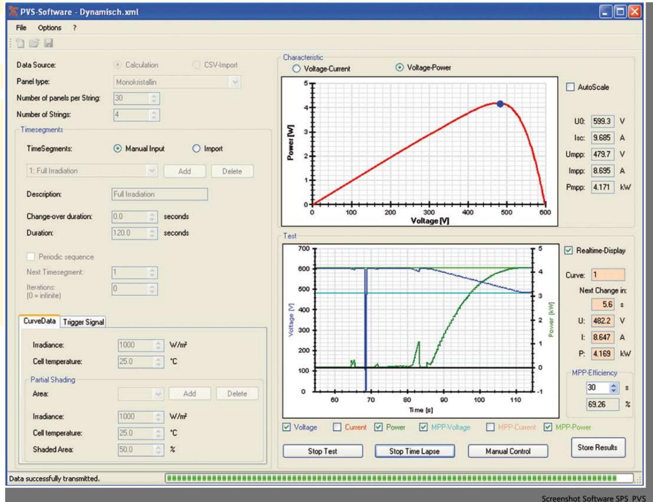
测试过程的编排为内置的测试软件所控制。软件能够计算或读取CSV格式的不同的V/I特征。间隔及瞬态时间均可由客户进行定义。设置太阳能光伏模拟系统的实时分析测试软件可以在其图形界面上完成。软件的实时控制和采集功能可以保证快速MPP跟踪及MPP效率值读取。
