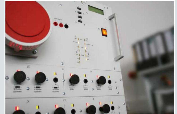
除了模拟太阳能逆变系统，我们的系统能够模拟各种太阳能逆变系统相关的电源波动现象（如电压频率波动，相位波动等）。相应的测试单元可以进行精密的电源谐波及闪烁测试。太阳能逆变器测试系统可以进行完全的反孤岛抑制检测。
