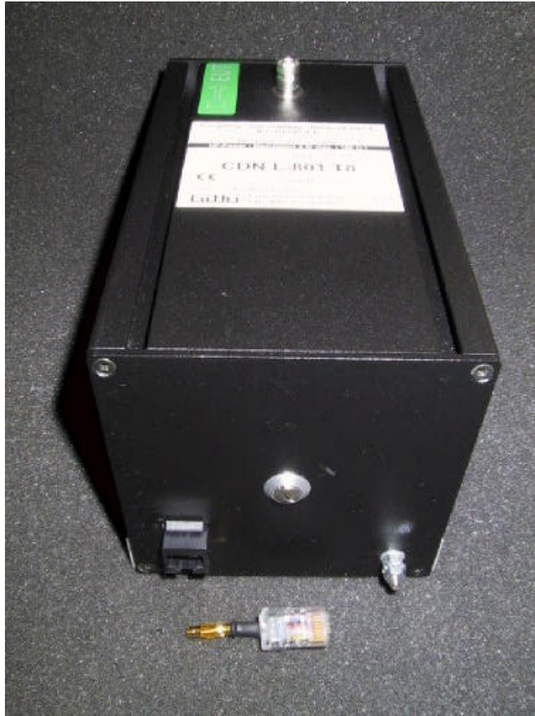
CDN, Erdsymmetrische Leitung, RJ 45 (ISDN)
