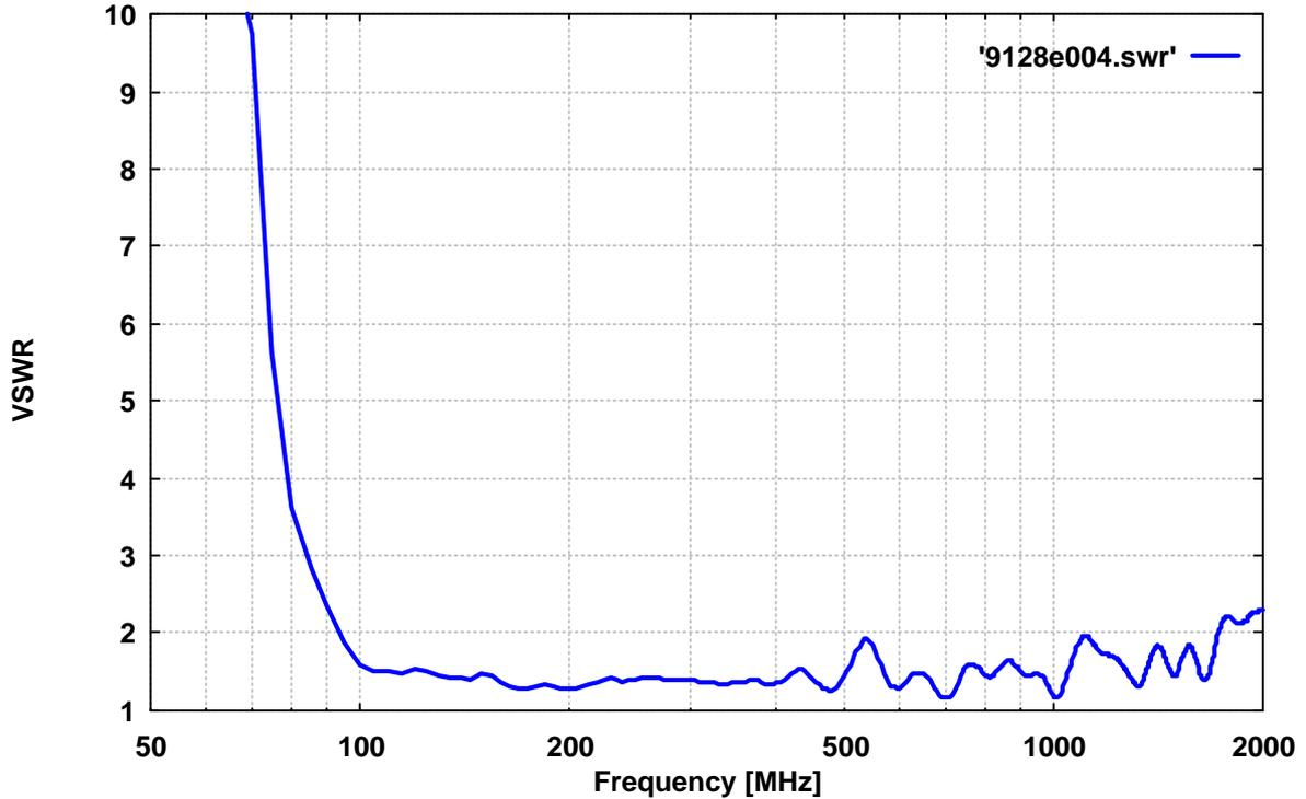
Zwischenschalten eines Dämpfungsgliedes ist zweckmäßig, wenn das angeschlossene Gerät ein hohes Eigen-SWR (z.B. in der 0 dB-Stellung des Eingangsteilers) aufweist. Dann ist diese Dämpfung zum Antennenwandlungsmaß zu addieren bzw. vom Gewinn abzuziehen.
